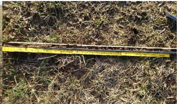
Abbildung 13: Vermessung der kulturfähigen Ober- und Unterbodenschicht mittels eines Meterstabes.
